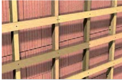
Sub estructuras en madera
