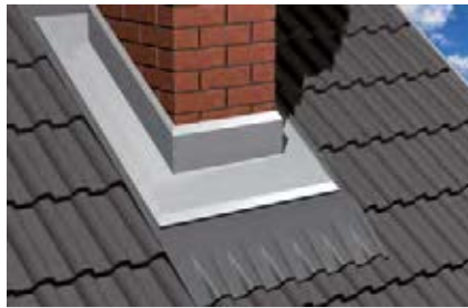
Sellado y pegado de zinguerías en techos
